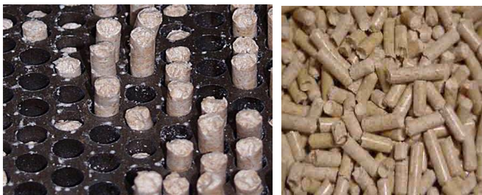
Abbildung 24: links: Matrize zur Herstellung von Pellets. (Quelle: HDG-BAVARIA 2006) rechts: Holzpellets
