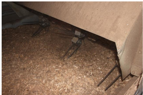
Abbildung 42: Schaufeln eines Schubwendetrockners befüllt mit Hackschnitzeln (Quelle: Rutz)
