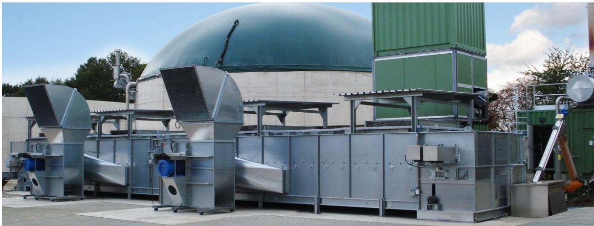
Abbildung 44: Bandtrockner für die Trocknung von Gärresten vor einer Biogasanlage (Quelle: STELA Laxhuber GmbH)
