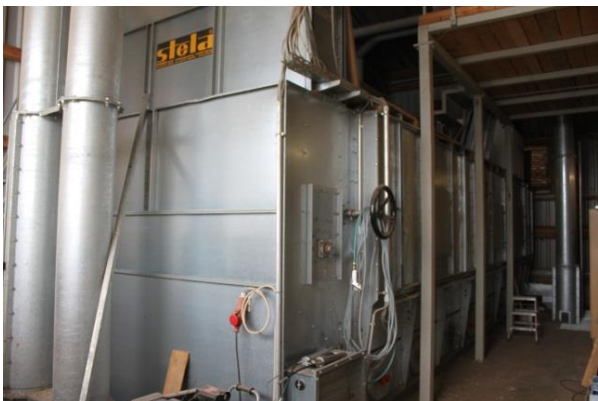
Abbildung 41: Schubwendetrockner in Deutschland (Quelle: Rutz)
