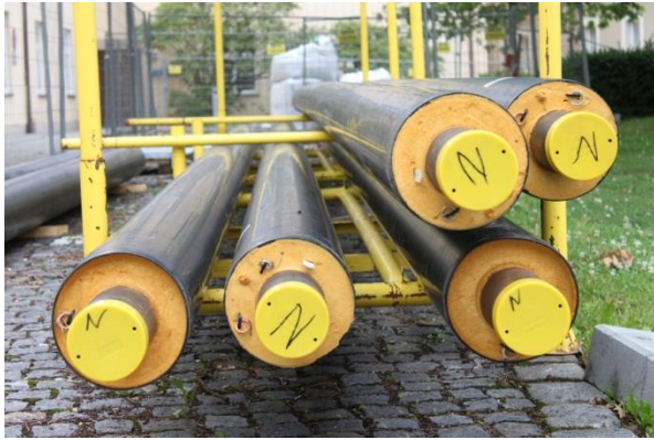
Abbildung 18: Isolierte Fernwärmeleitungen aus Stahl in Deutschland (Quelle: Rutz)
