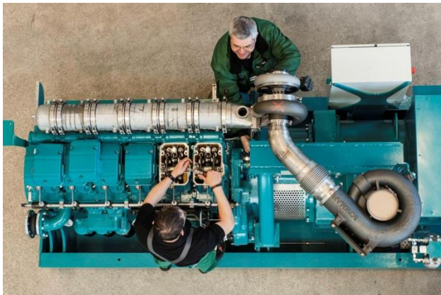
Abbildung 61: Zündstrahlmotor mit einer Leistung von 235 kW el und integrierter Abgasturbine mit einer Leistung von 30 kW el (Quelle: Schnell Motoren AG)
