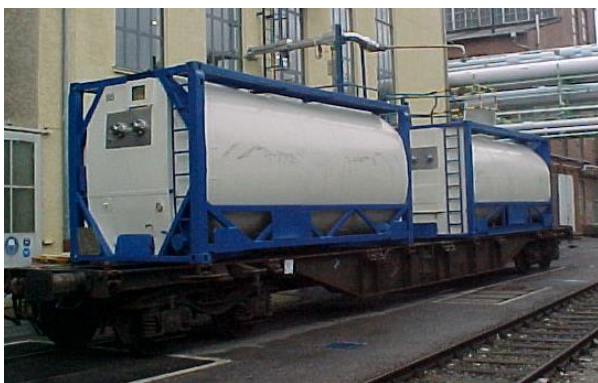
Abbildung 30: Zugwagen der mit einem Latentwärmespeichersystem beladen wurde (Quelle: TransHeat GmbH)
