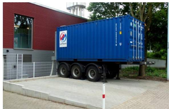
Abbildung 31: Anhänger mit Container und Wärmespeicherungssystem (Quelle: LaTherm GmbH)
