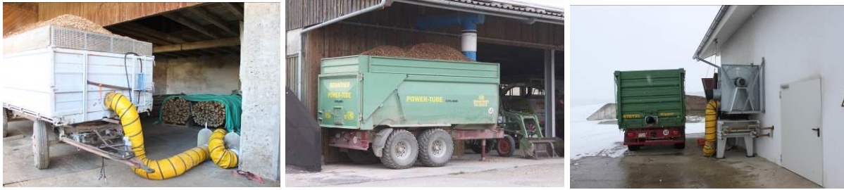
Abbildung 43: Beispiele von einfachen Satztrockner zur Hackschnitzeltrocknung auf Anhängern (Quelle: Rutz)
