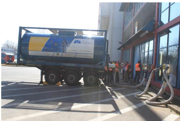
Abbildung 32: Wärmespeicher-Container auf einem Anhänger auf einer Abfallverbrennungsanlage (Augsburg, Deutschland) (Quelle: Rutz)
