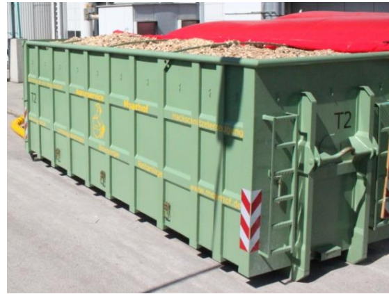
Abbildung 47 Container für die Holzhackschnitzeltrocknung in München, Deutschland (Quelle: Rutz)
