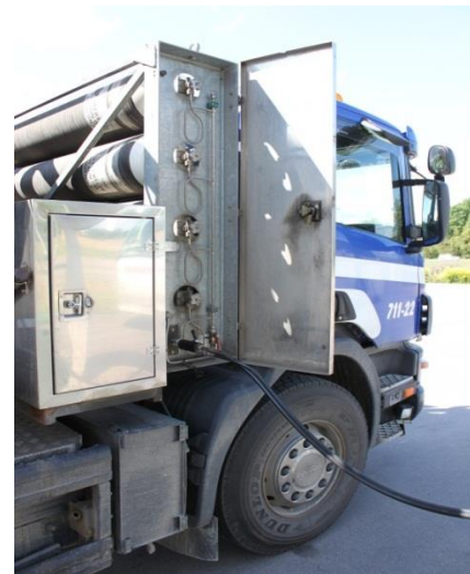
Abbildung 71: Biomethanflaschen hinter dem Führerhaus eines Lasters, Schweden (Quelle: Rutz)
