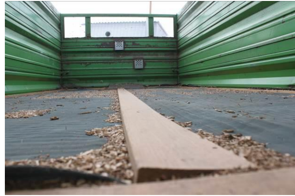
Abbildung 38: Eigene Konstruktion eines Satzrockners mit durchlöcherntem Doppelboden (Quelle: Rutz)
