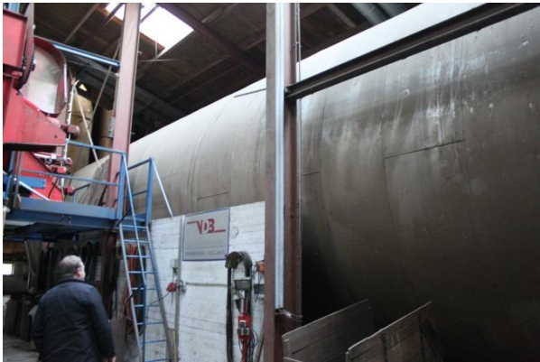
Abbildung 39: Trommeltrockner zur Trocknung von Grasschnitt in Deutschland (Quelle: Rutz)
