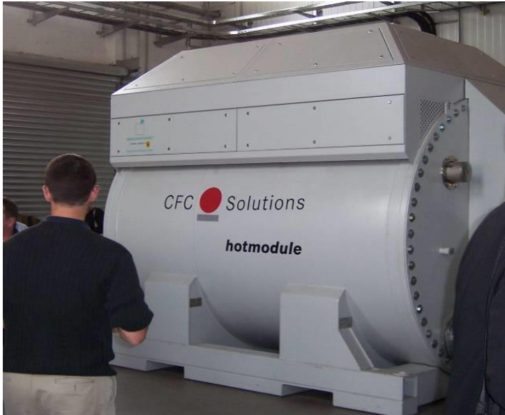
Abbildung 3: Schmelzkarbonatbrennstoffzelle (MCFC) für Biogas in Leonberg, Deutschland (Quelle: Rutz)
